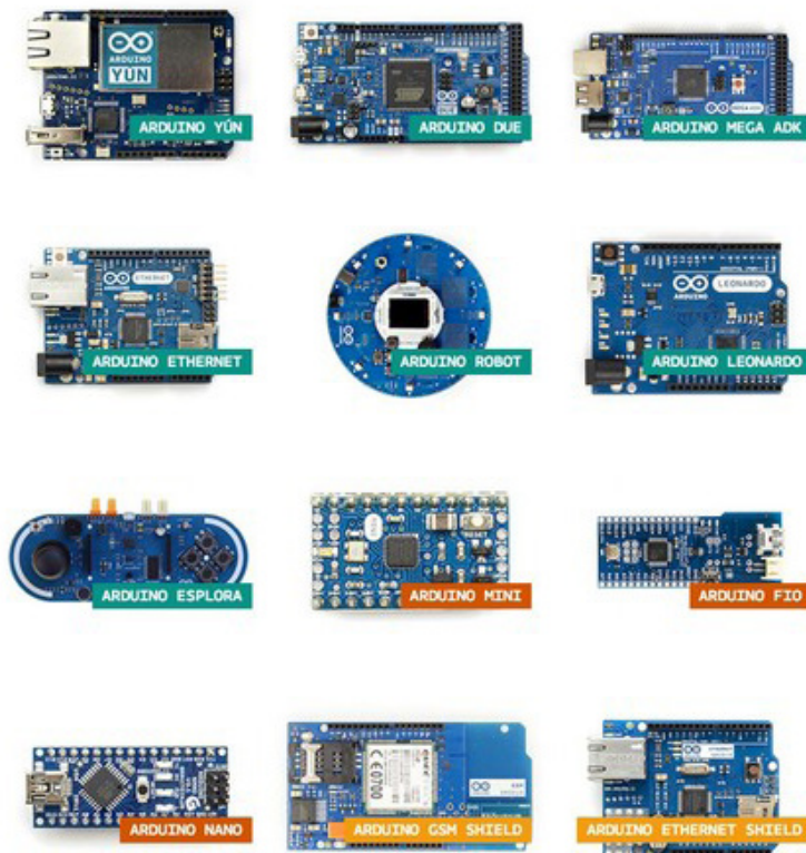
Figura 2. Muestra de las diferentes versiones de placas de desarrollo que puedes encontrar del proyecto Arduino
